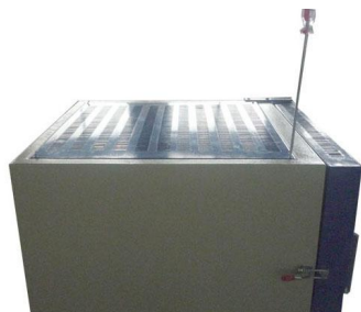
用内六角扳手拧开炉盖上的螺丝
